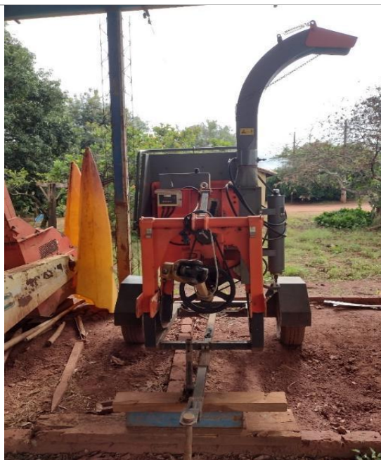
Figura 161: Equipamento Picador – Triturador utilizado para resíduos de poda e capina pela Prefeitura Municipal de Santa Vitória – MG
