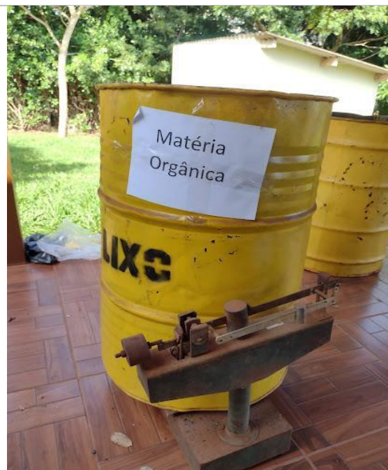
Figura 135: Triagem e pesagem das amostras de resíduos coletados em Santa Vitória – MG para a avaliação da composição gravimétrica
