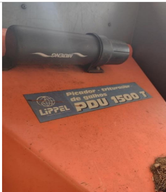
Figura 162: Equipamento Picador – Triturador utilizado para resíduos de poda e capina pela Prefeitura Municipal de Santa Vitória – MG
