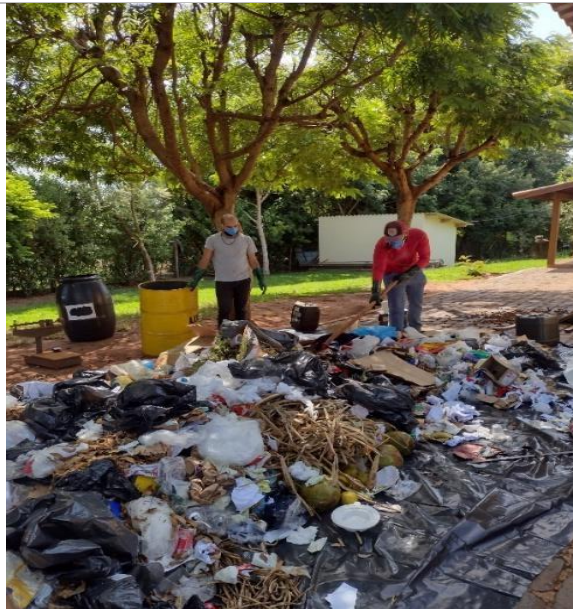
Figura 132: Homogeneização e quarteamento dos resíduos coletados Santa Vitória – MG
