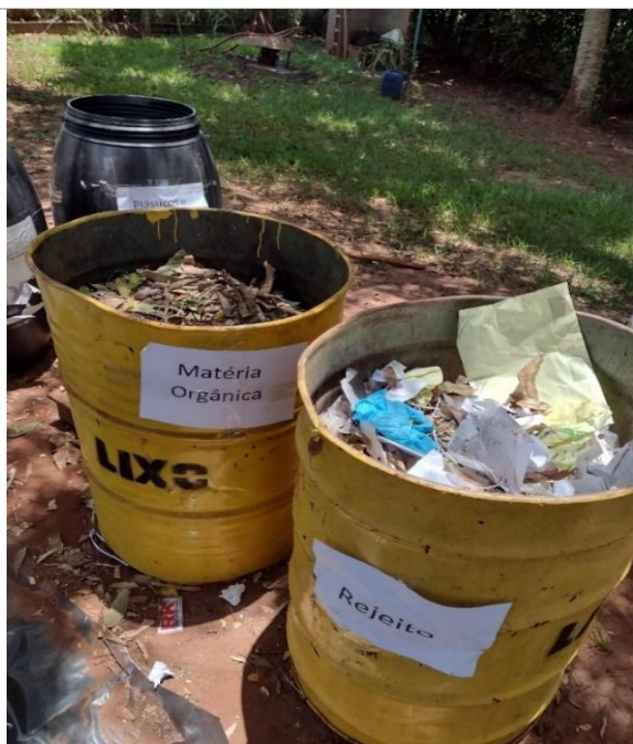
Figura 134: Triagem e pesagem das amostras de resíduos coletados em Santa Vitória – MG para a avaliação da composição gravimétrica
