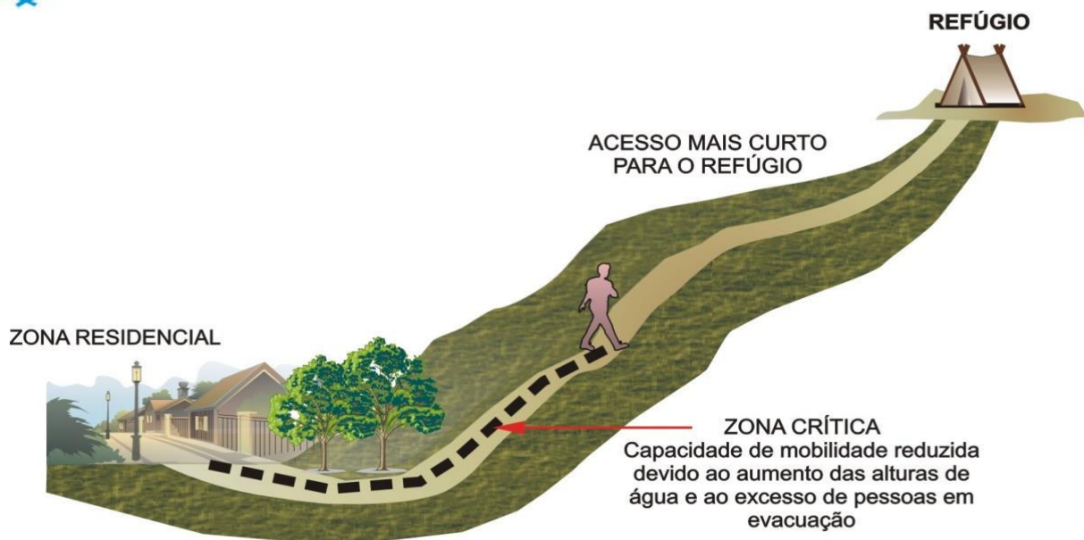
Figura 50 - Acesso a refúgios. Identificação de zonas críticas.
